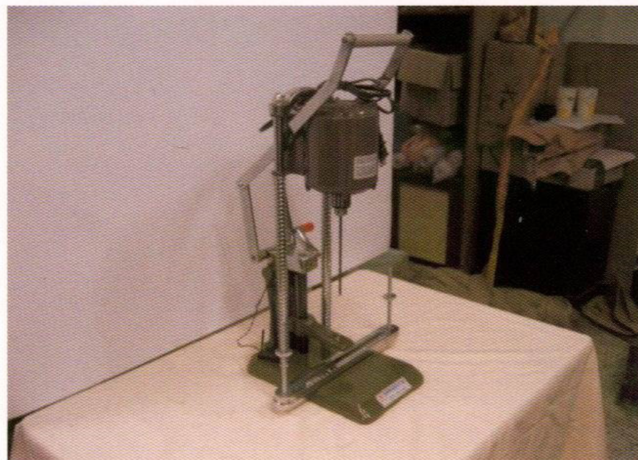
電動穿孔機 裝訂傳票用 厚度可鑽 14 公分 NEW-NO-2002 型
